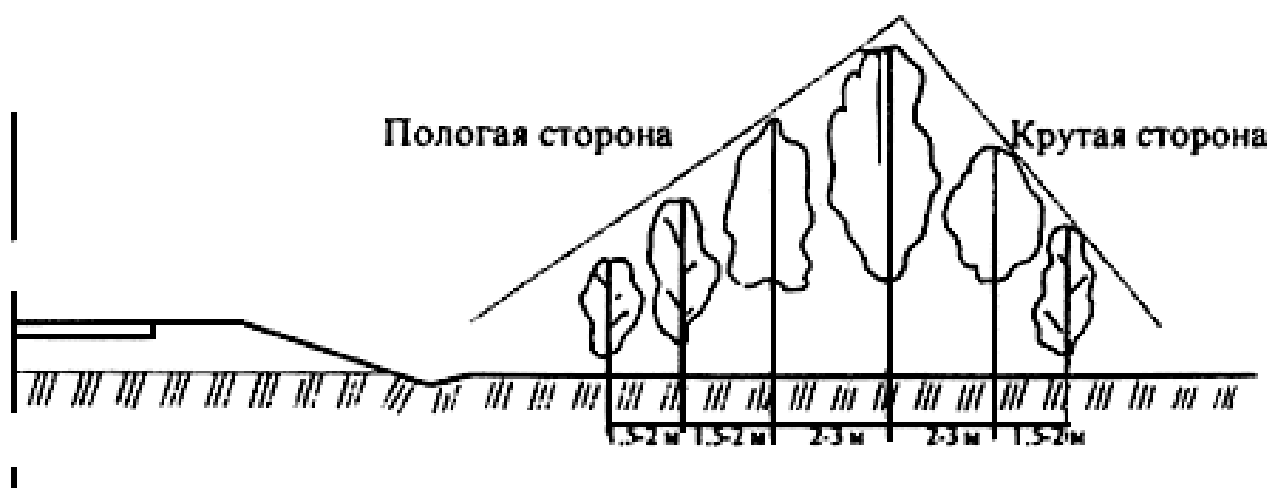
Рисунок 21 - Схема шумо-газо-пылезащитных насаждений:
