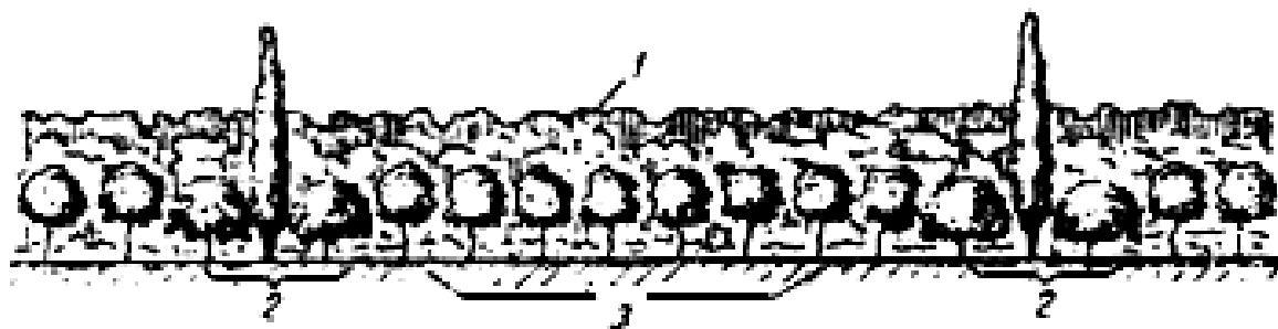
Рисунок 25 - Пример регулярного размещения декоративных деревьев на фоне монотонных снегозащитных лесных полос: 1 - снегозащитная полоса; 2 - декоративный акцент; 3 - регулярные декоративные посадки
