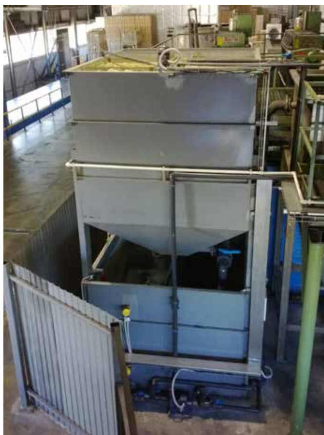
Рисунок 9. Внешний вид многокамерной флотационной механической машины
