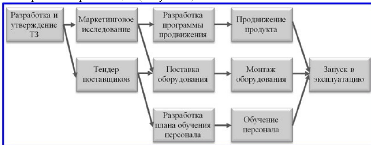
Рисунок 4. Пример сетевой диаграммы метода «вершина – работа» [9]
