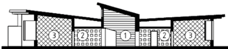
Рис. 3. Поперечный разрез специализированной школы в г. Глазго: 1 – галерея; 2 – буферные холлы; 3 – классные комнаты
