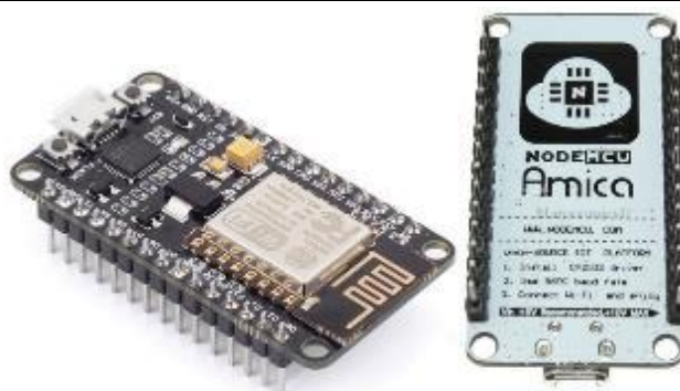
Рис. 5. WiFi плата NodeMCU та схема її будови
