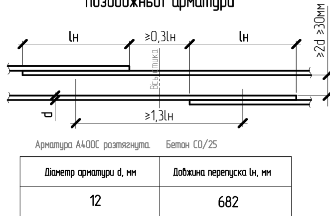
Схема стикування поздовжньої арматури
