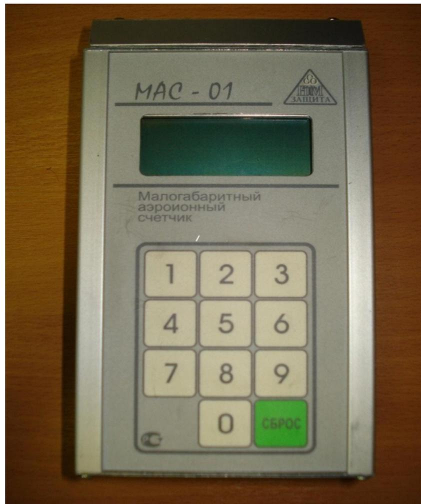
Счетчик аэроионов «МАС-01» представляет собой конструкцию с автономным питанием и расположением заборного окна сзади и сверху счетчика, и выпускного окна сзади и в нижней части счетчика.
