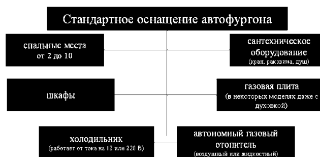
Рис. 2. Техническое оснащение внутреннего пространства автофургонов
